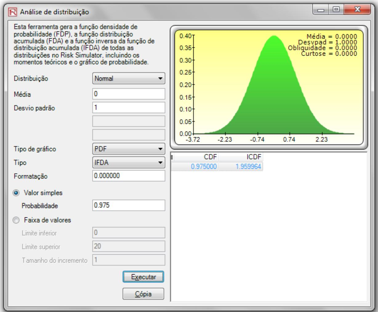
**Figura 5.37 – Ferramenta Análise da distribuição (IFDA e escore Z da distribuição normal)**
