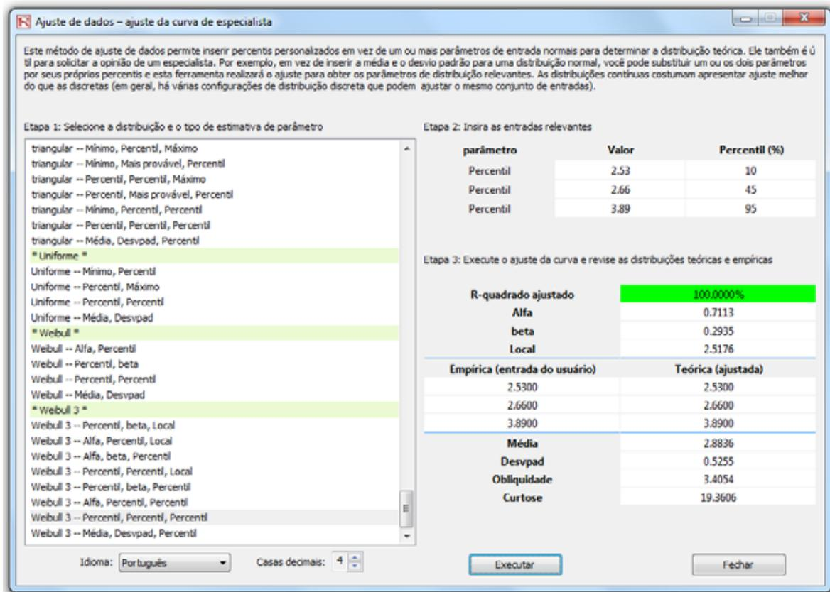
Figura 5.47 – Ferramenta de ajuste da distribuição percentil
